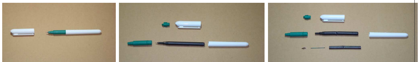
Abbildung 14: Mögliche Zerlegungen eines Filzschreibers in Komponenten. In der mittleren Abbildung ist die Mine ein einzelnes Untersystem, in der rechten Abbildung wurde die Mine weiter zerlegt.
